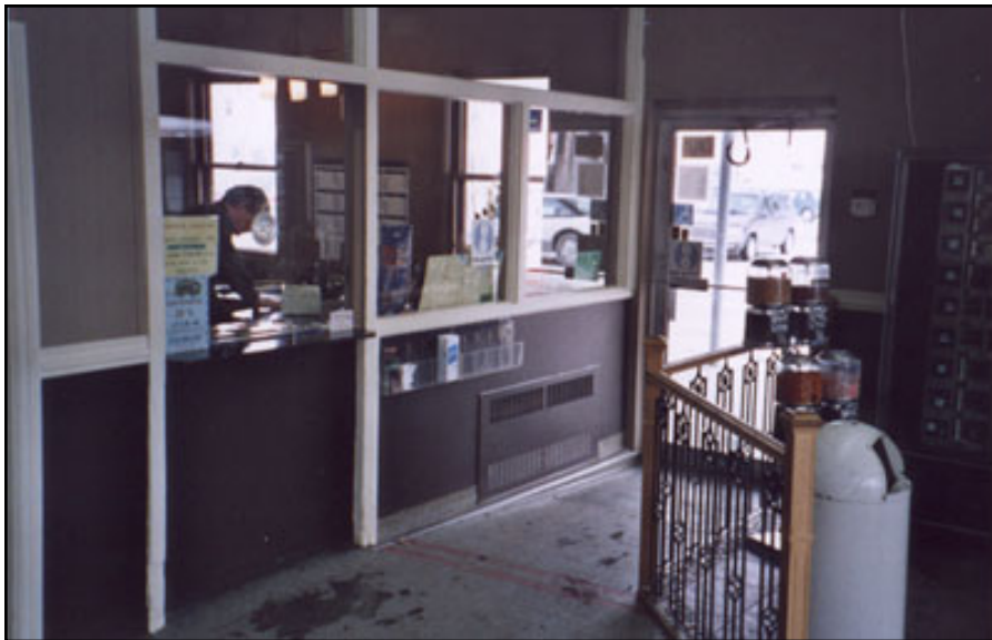
Une partie du comptoir doit être abaissée avec un dégagement en dessous.
